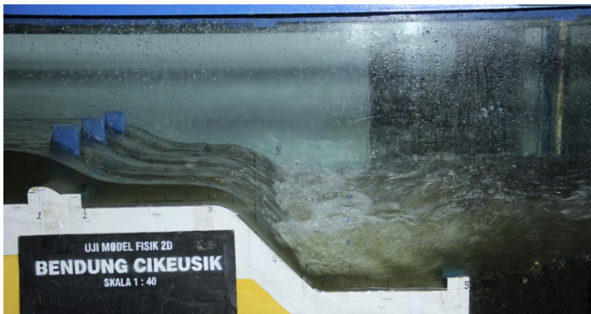
Gambar 15 Kondisi pengaliran pada model Bendung Cikeusik alternatif 1 di laboratorium
