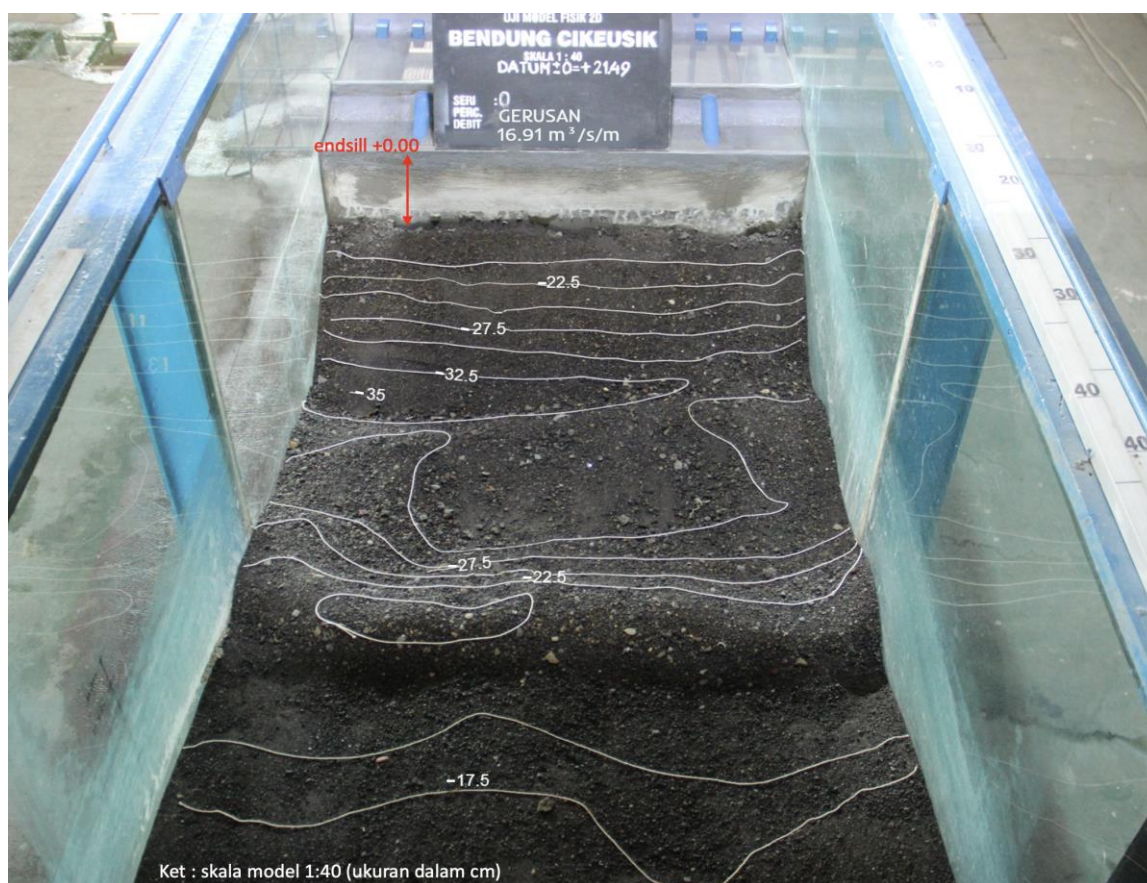
Gambar 13 Pola gerusan pada model Bendung Cikeusik desain eksisting Q_{100} tahun di laboratorium
