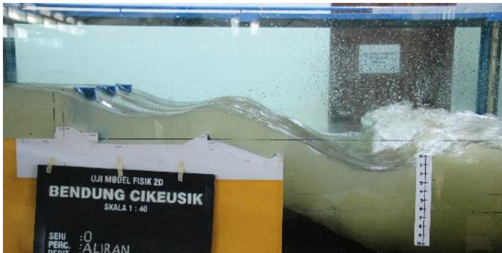
Gambar 11 Kondisi pengaliran pada model Bendung Cikeusik Eksisting Q_{100 \text{ tahun}} di laboratorium
