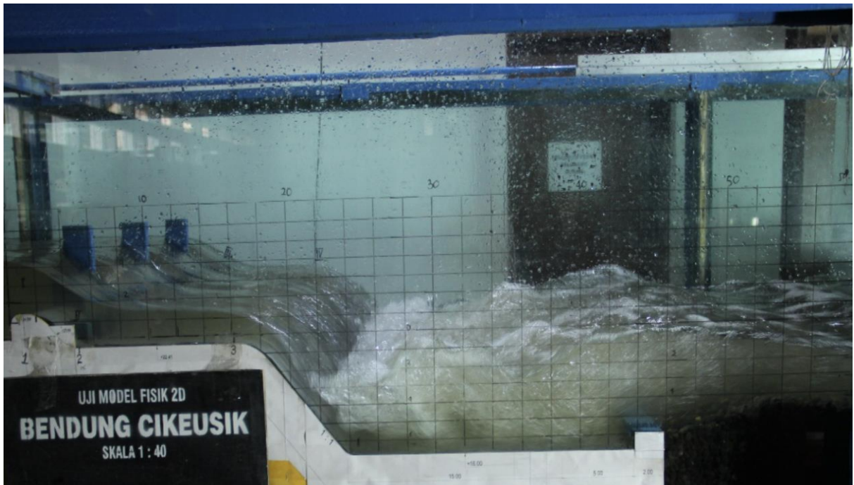
Gambar 16 Kondisi pengaliran pada model Bendung Cikeusik alternatif 2 di laboratorium
