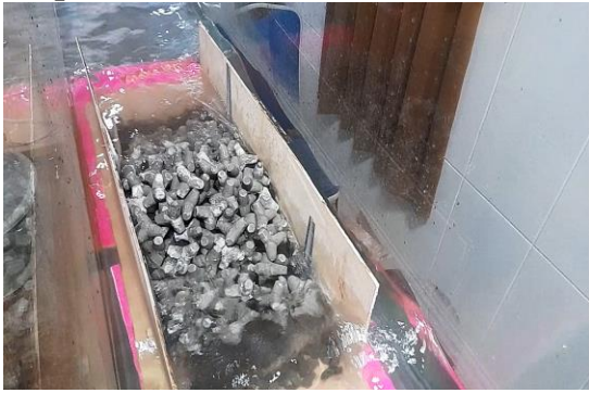
Pengambilan data dengan breakwater tetrapod pada d=17 cm di wave flume dengan T=1 s
