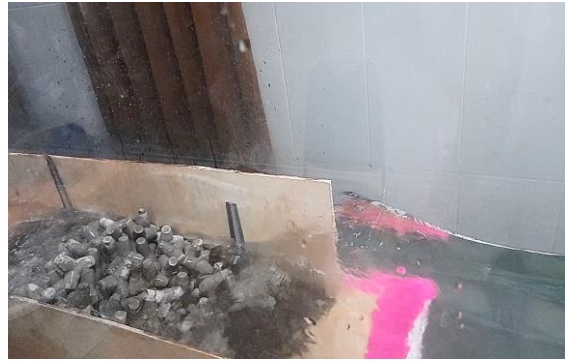
Pengambilan data dengan breakwater tetrapod pada d=17 cm di wave flume dengan T=0.8 s
