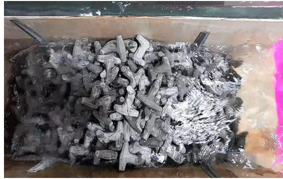
Pengambilan data dengan breakwater dolos pada d=17 cm di wave flume dengan T=0.9 s
