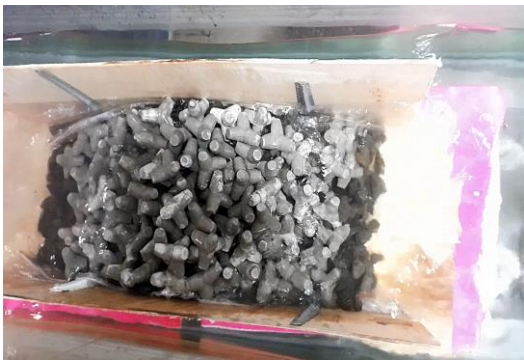
Model fisik breakwater tetrapod yang diujikan pada wave flume
