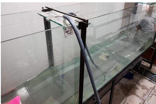
Sensor ultrasonik yang dipasang pada wave flume
