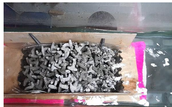
Pengambilan data dengan breakwater dolos pada d=15 cm di wave flume dengan T=0.8 s
