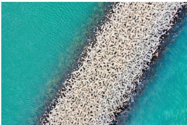
**Gambar 1.** Struktur Lapis Lindung Dolos pada Sebuah *Breakwater*
