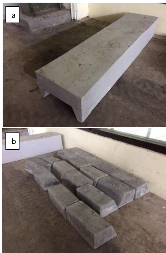
Gambar 1 Benda uji (a: model ponton beton pemecah gelombang apung, b: model jangkar)
