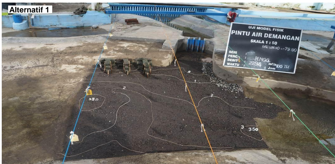
Gambar 15 Pola gerusan yang terjadi pada uji model fisik 3 dimensi (Alternatif 1, Q_{100thn} )
