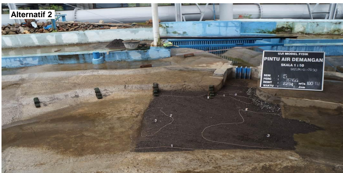
Gambar 16 Pola gerusan yang terjadi pada uji model fisik 3 dimensi (Alternatif 2, Q_{100thn} )
