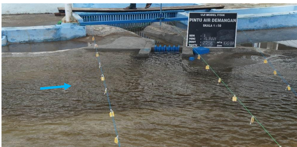
Gambar 7 Pengaliran model Sungai Bengawan Solo dengan Q_{100th}
