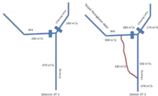
Gambar 16 Ilustrasi perubahan debit puncak banjir akibat ITBT-1
