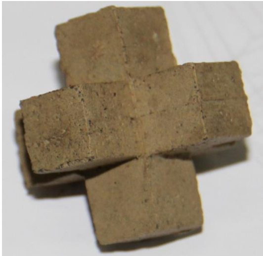
Gambar 5 Model BBT Kubus Kaki Enam Skala 1:33%
