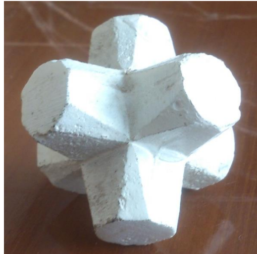
Gambar 6 Model BBT Kubus Kaki Enam Hasil Pengembangan Skala 1:33%
