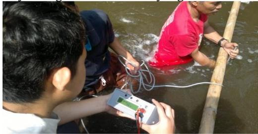
**Gambar 13** Pengujian di Lapangan *Counter* hasil pengembangan dengan *Current Meter* tipe C31
