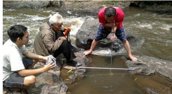
**Gambar 14** Pengujian di Lapangan *Counter* hasil pengembangan dengan *Current Meter* tipe *Pigmi*
