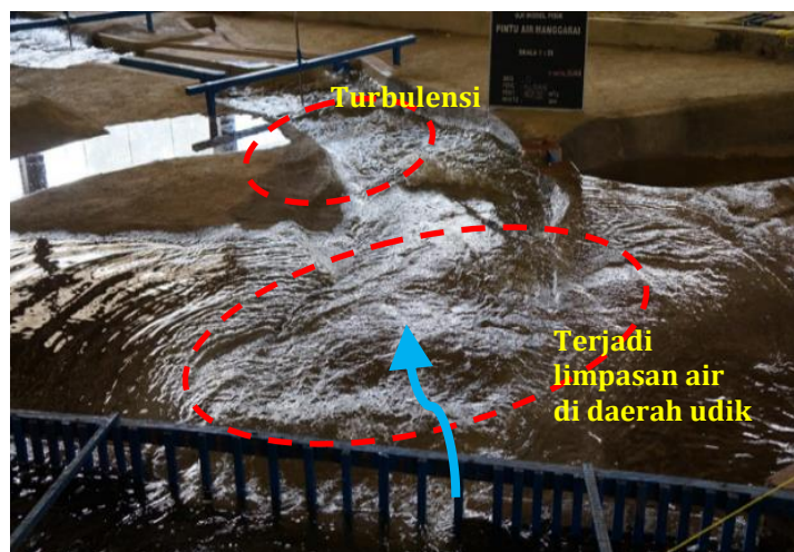
Gambar 9 Model fisik Pintu Air Manggarai seri 1 dengan debit pengaliran Q_{25th}
