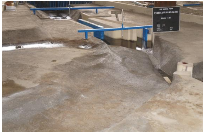
Gambar 8 Model fisik Pintu Air Manggarai seri 1 dengan Skala 1:25, kondisi sebelum percobaan pengaliran
