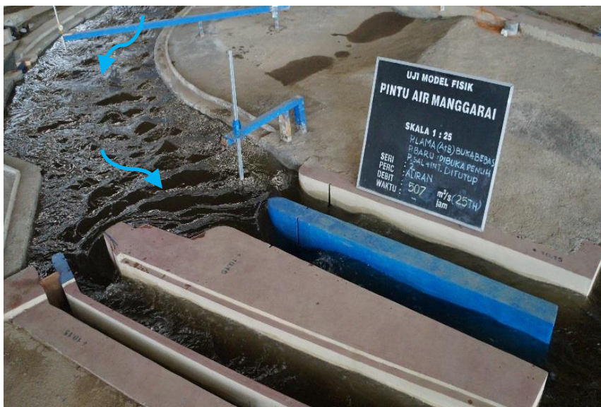
Gambar 15 Model fisik Pintu Air Manggarai seri 2 dengan debit pengaliran Q_{25th}
