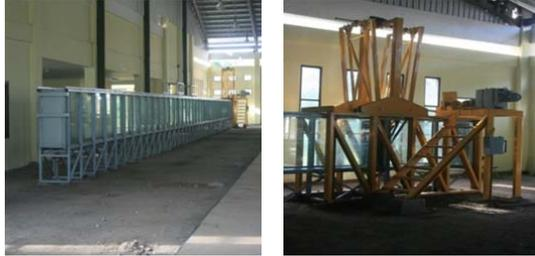
Gambar 1 Saluran Flume Balai Pantai dan wave generator
