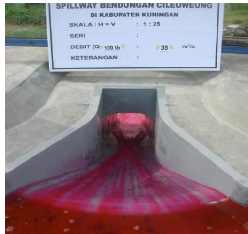
Gambar 7 Pola aliran di Pelimpah
