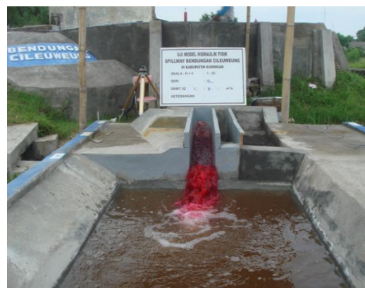
Gambar 13 Pola aliran di kolam olakan dan di plunge pool
