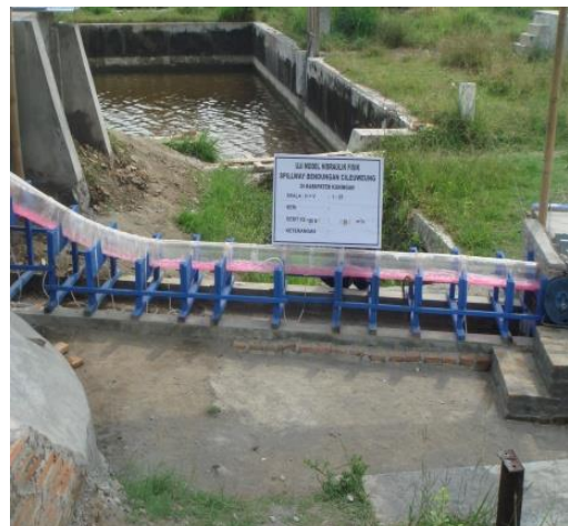
Gambar 8 Pola aliran di saluran luncur
