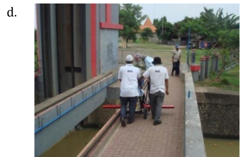
Gambar 8 (a-d) Proses pengukuran georadar di tubuh bendung pada arah memanjang.
