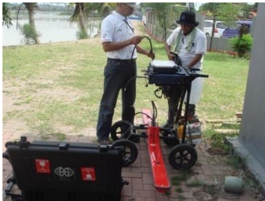
Gambar 7 Proses instalasi peralatan pengukuran, georadar.
