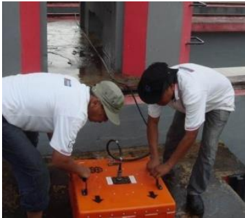
Gambar 9 (a-c) Proses pengukuran georadar di tubuh bendung pada arah melintang.
