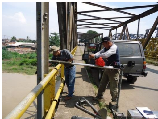
Gambar 5 Pengambilan sedimen di jembatan Citarum
