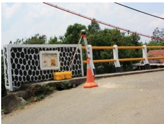
Gambar 3 Pemantauan dengan RTK di Sapan
